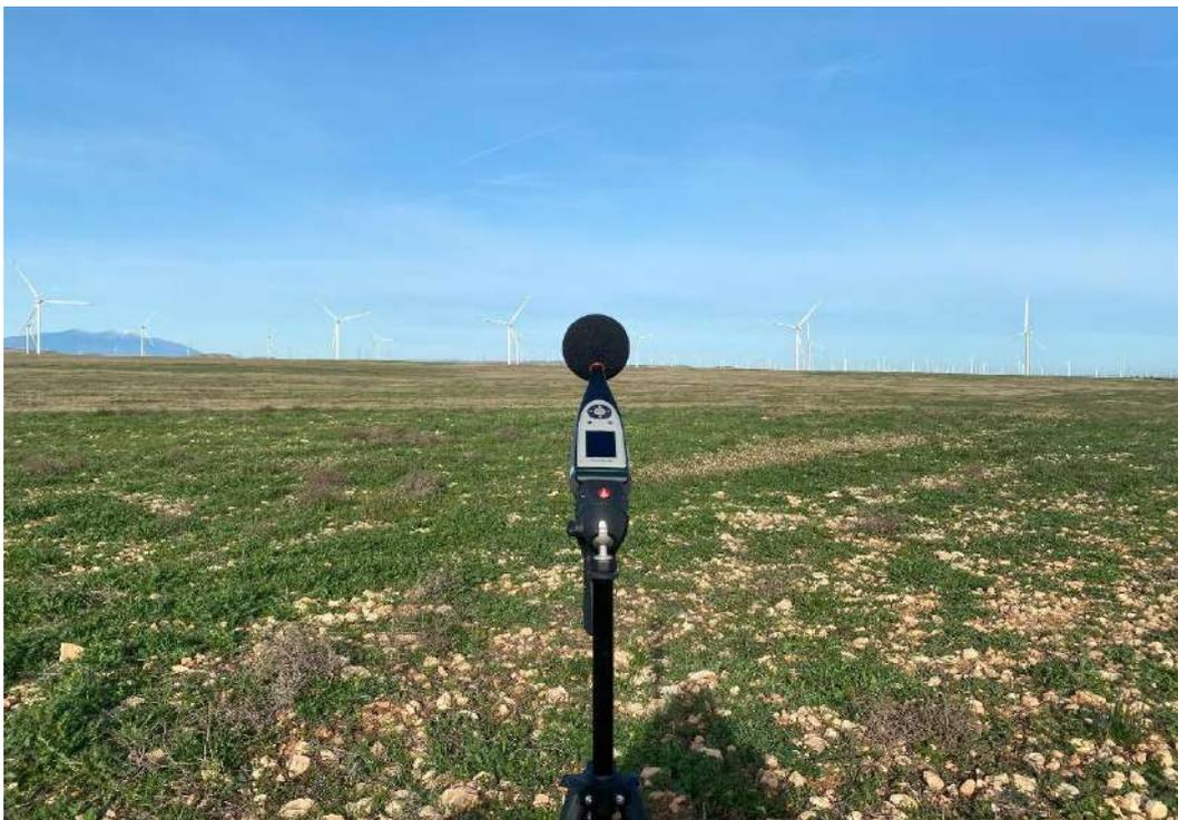
**Foto nº6.** Medición de ruido diurno en el punto de medición RPE-05, con el PE Pedrola al fondo de la imagen.
