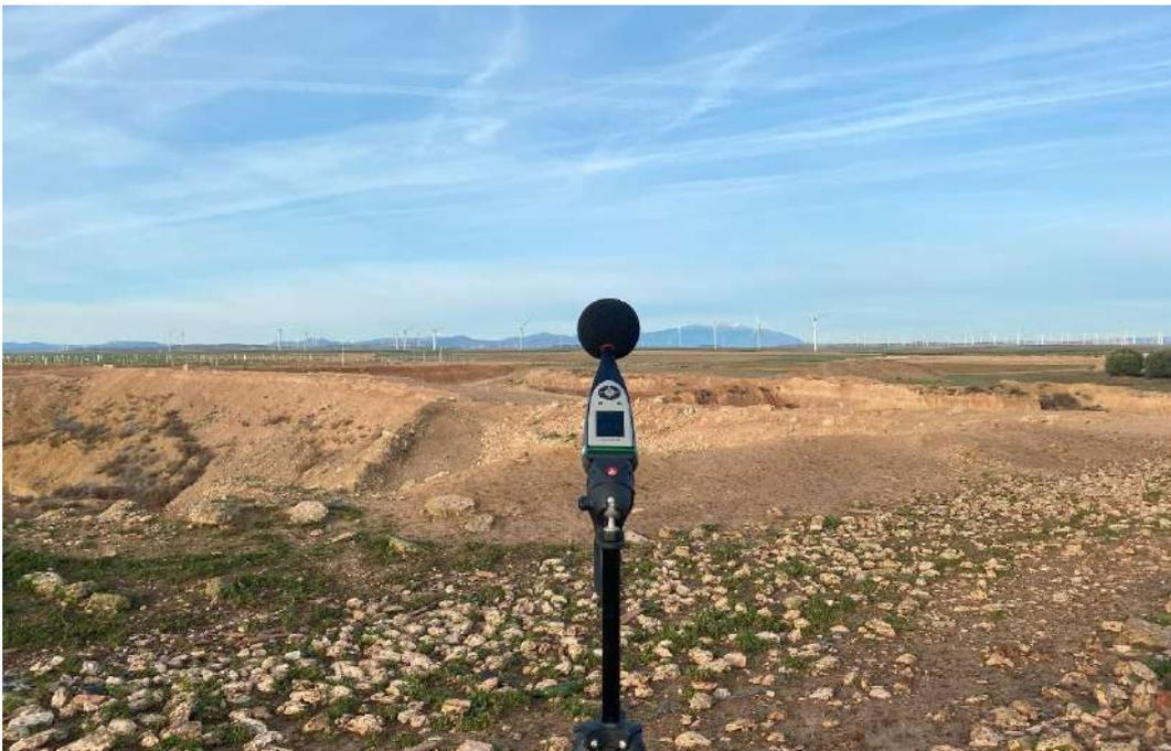
**Foto nº2.** Medición de ruido diurno en el punto de medición RPE-03, con el PE Pedrola al fondo de la imagen.
