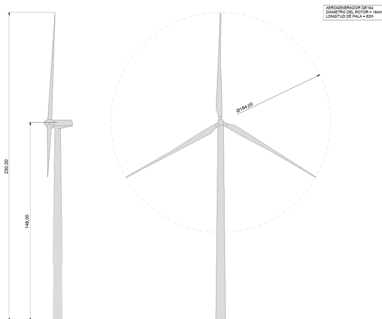
Figura 8. Alzado y perfil de aerogenerador tipo GE164
