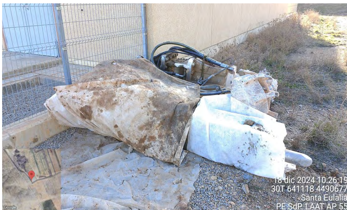
Fotografía 16. Maquinaria envuelta y sobre material absorbente con los latiguillos atados junto al apoyo 55 de la LAAT
