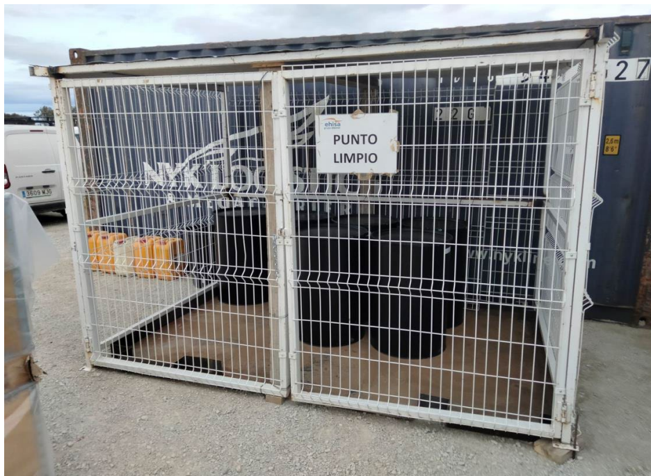
Fotografía 10. Punto limpio de residuos peligrosos
