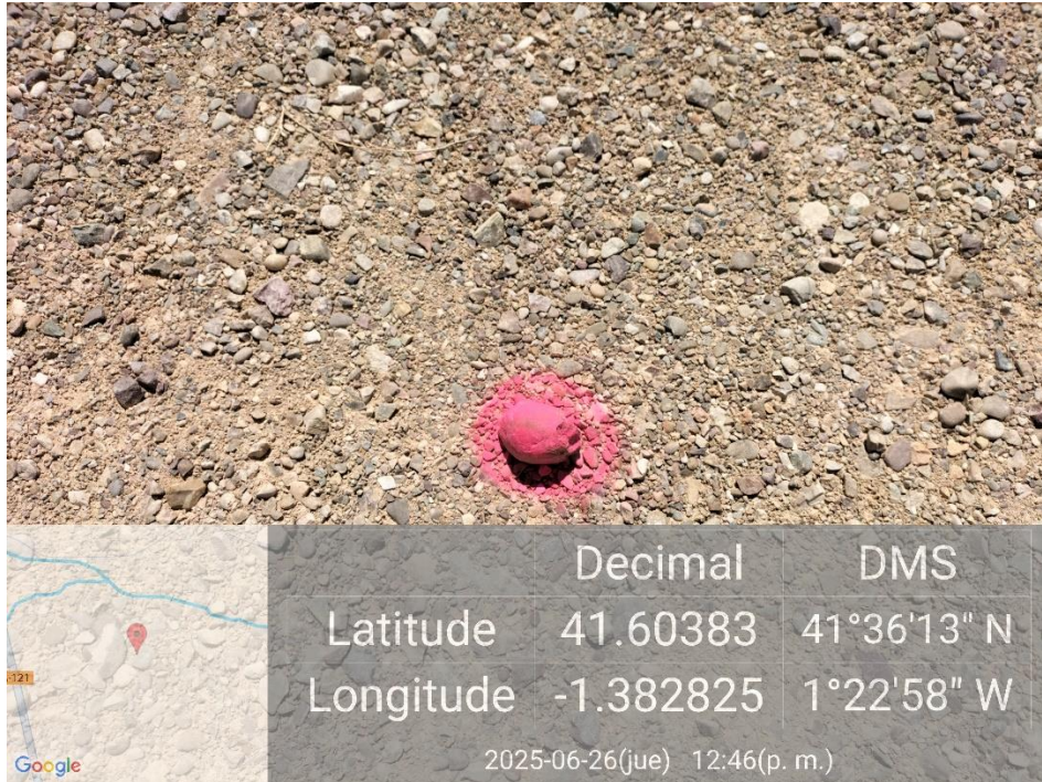
Ilustración 15. Roca y suelo marcados con pintura, se recomienda el uso exclusivo de estacas.
