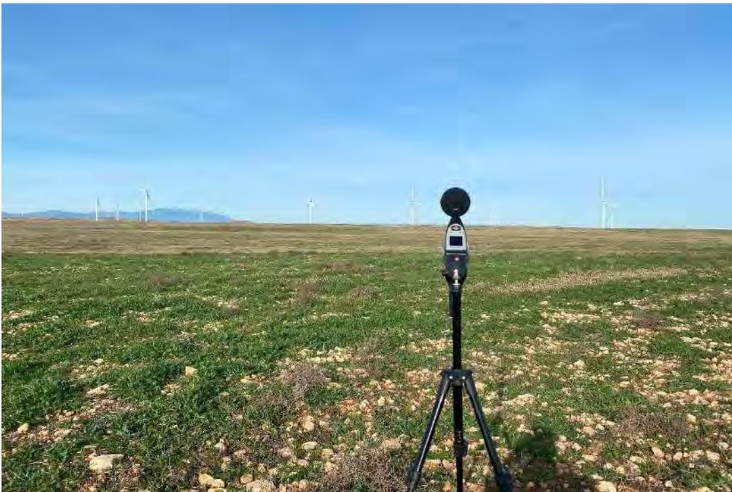
**Foto nº4.** Medición de ruido diurno en el punto de medición RPA-05.
