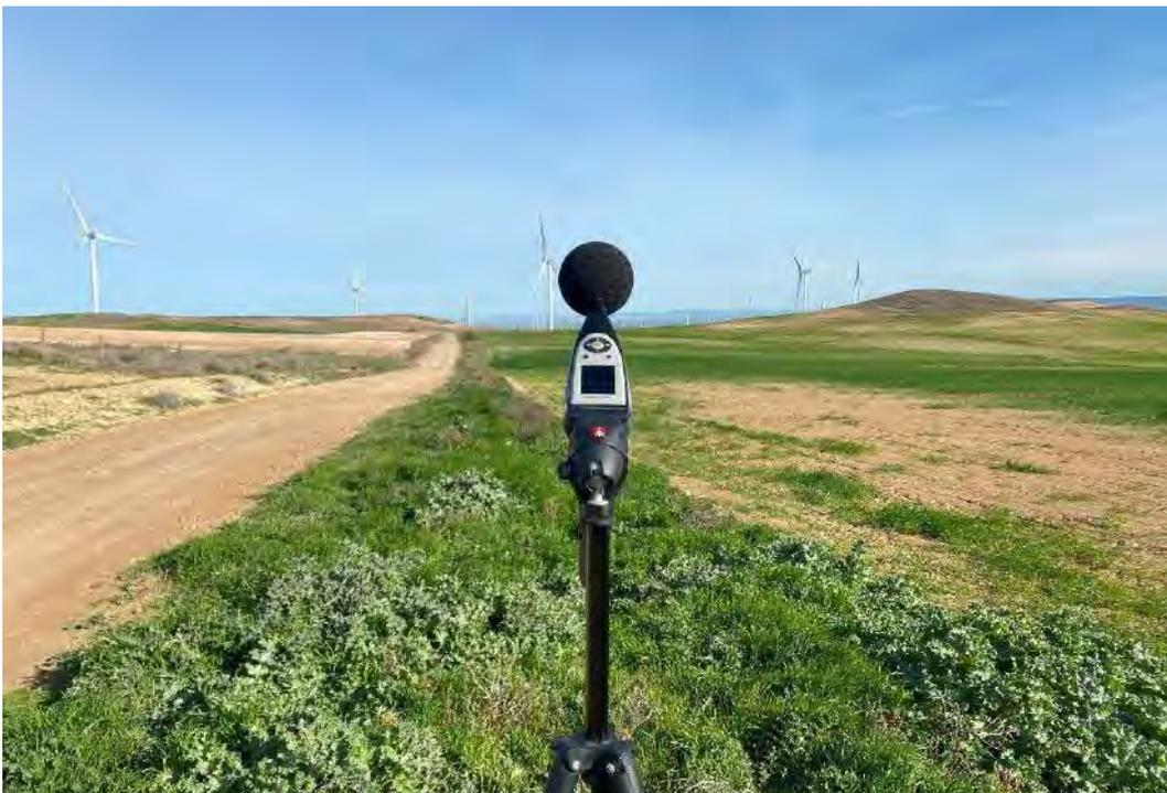
**Foto nº2.** Medición de ruido diurno en el punto de medición RPA-01.
