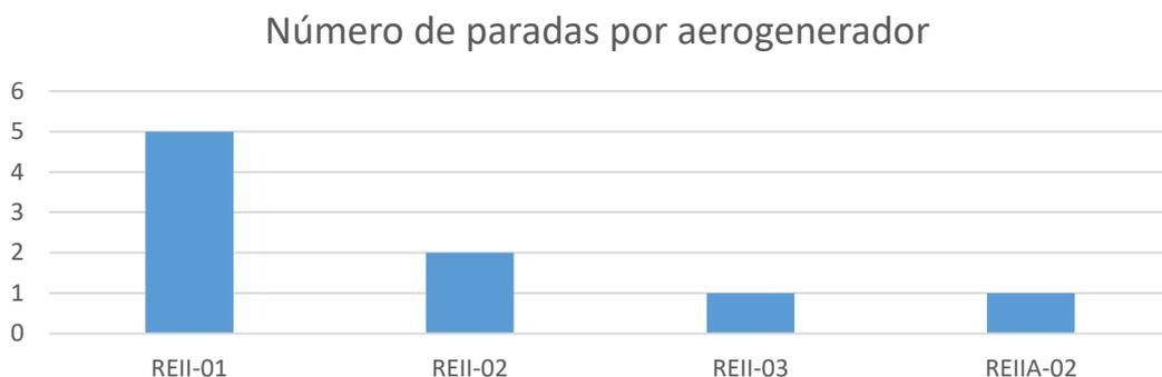
**Figura nº 5:** Número de paradas por aerogenerador efectuadas por el dispositivo 3D Observer instalado en la posición REII-01. Únicamente se incluyen las paradas principales, pudiendo existir más ordenes de parada una vez ya se encuentra parado el aerogenerador, retardando así la reactivación.
