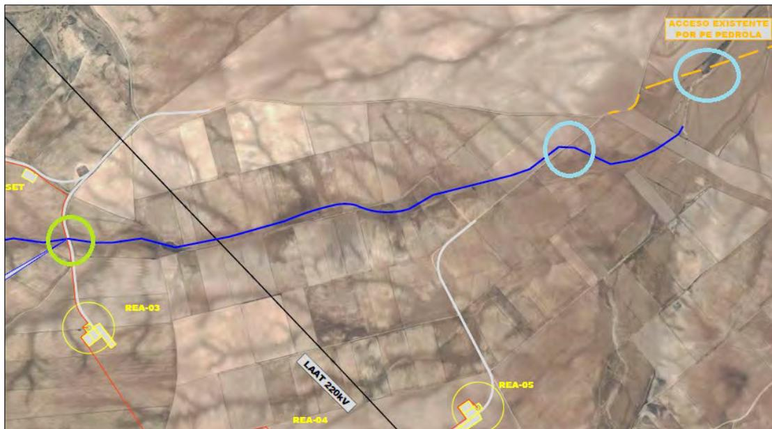
**Fig.1:** En verde cruce del barranco innominado recogido en la documentación aportada. En azul afectación al barranco innominado y barranco del Tollo por los viales de acceso al aerogenerador REA-05 y al parque eólico.
