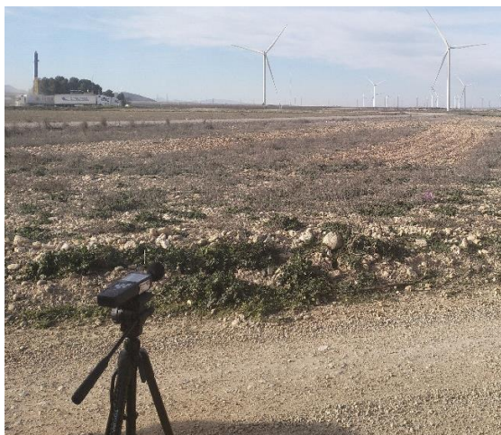
Imagen 36. Mediciones con sonómetro en área de influencia PE Los Cierzos.
