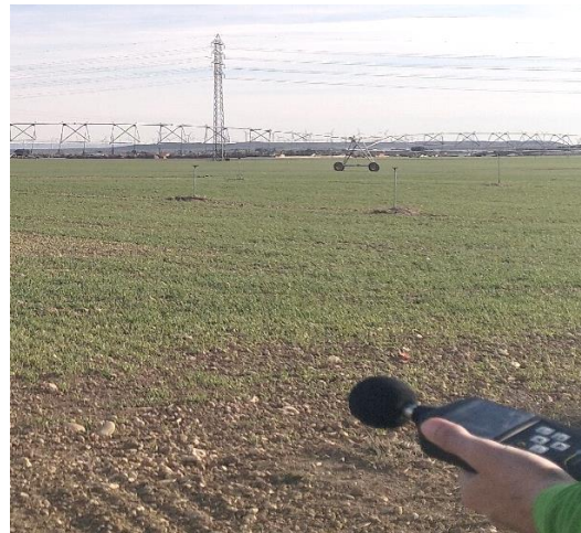
Imagen 36. Mediciones con sonómetro en área de influencia PE Los Cierzos.
