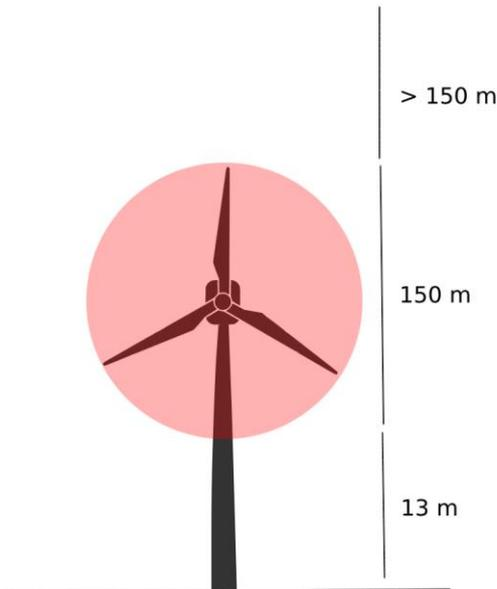
Figura 4. Rango de alturas para aerogeneradores de "La Cometa I". Fuente: Ideas Medioambientales S.L.
