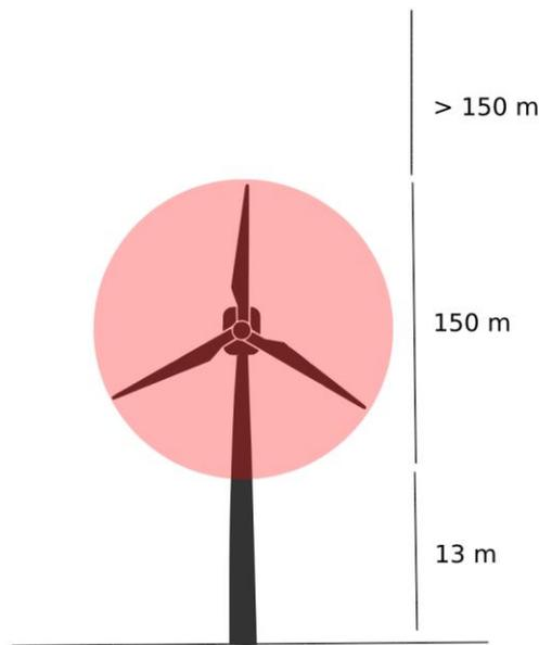
Figura 3. Rango de alturas para aerogeneradores de "La Cometa II". Fuente: Ideas Medioambientales S.L.
