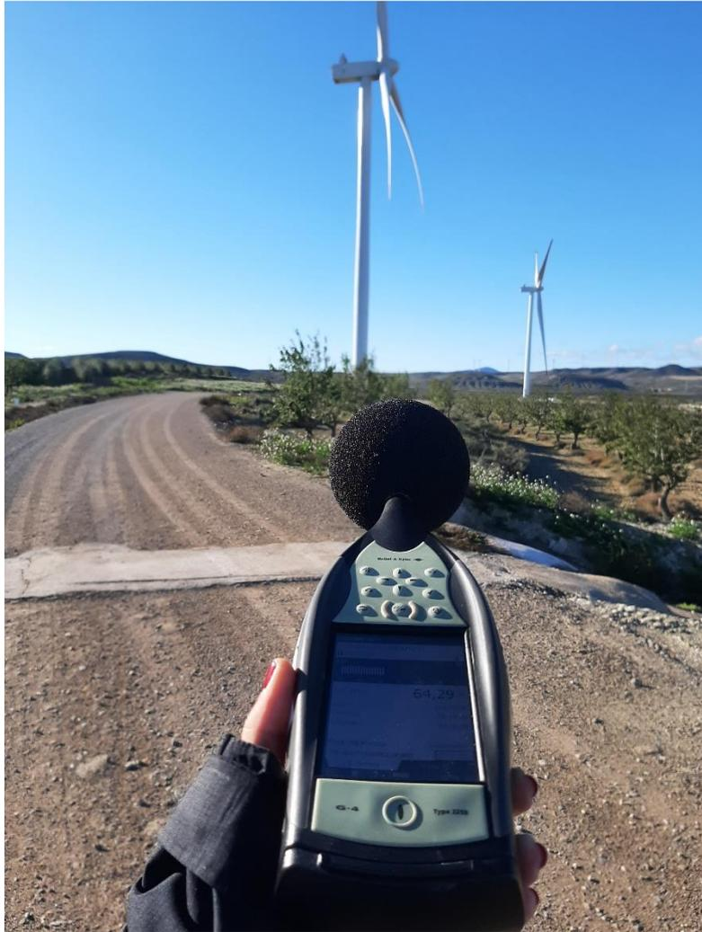
Figura 32: Sonómetro integrador modelo CESVA SC310 utilizado para la evaluación de los niveles de presión sonora en el parque eólico “El Tollo”.
