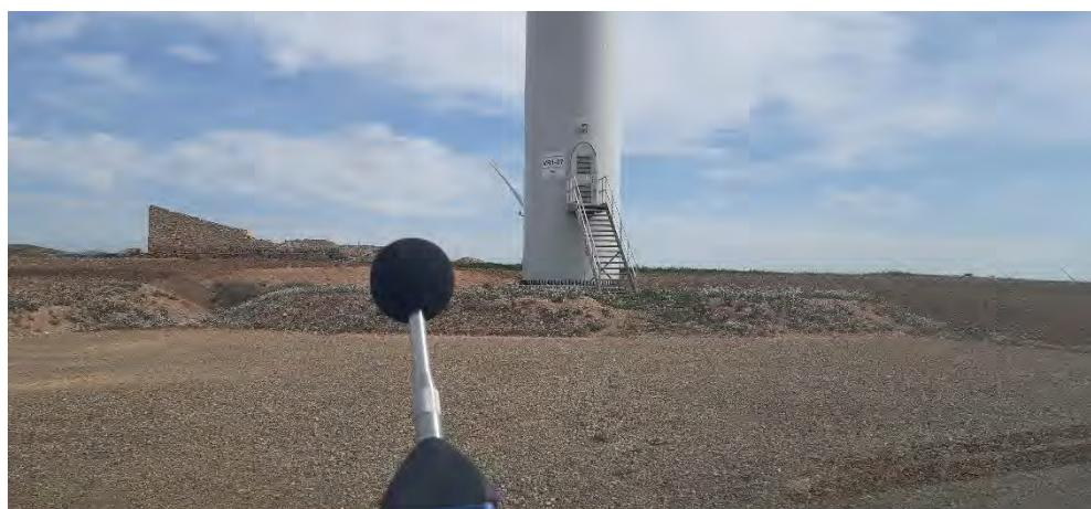
Medición sonómetro en VR1.07. Aerogenerador parado. Viento suave
