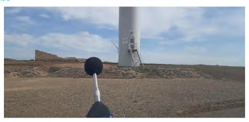
Medición sonómetro en VR1.07. Aerogenerador parado. Viento suave
