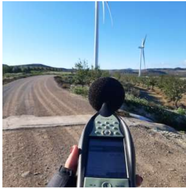
Figura 1: Sonómetro integrador modelo 2250 (G4) de Brüel & Kjaer utilizado para la evaluación de los niveles de presión sonora en el parque eólico “Tinajeros”.
