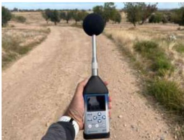
**Figura 36:** Sonómetro integrador modelo CESVA SC310 utilizado para la evaluación de los niveles de presión sonora en el parque eólico “Tinajeros”.
