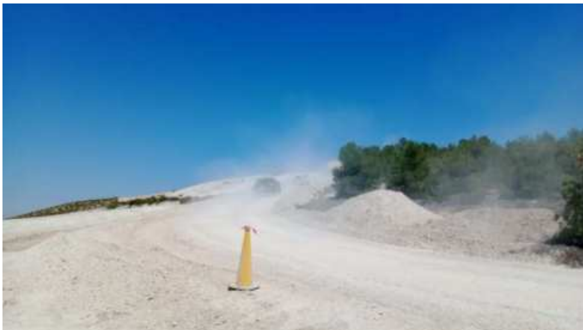
Imagen 3. Ejemplo del polvo en vial principal pese a circular a velocidad baja.
