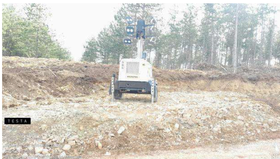
Generador sin protección de suelo en SE1-3
