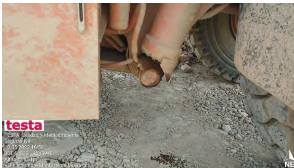
Maquinaria con derrames
