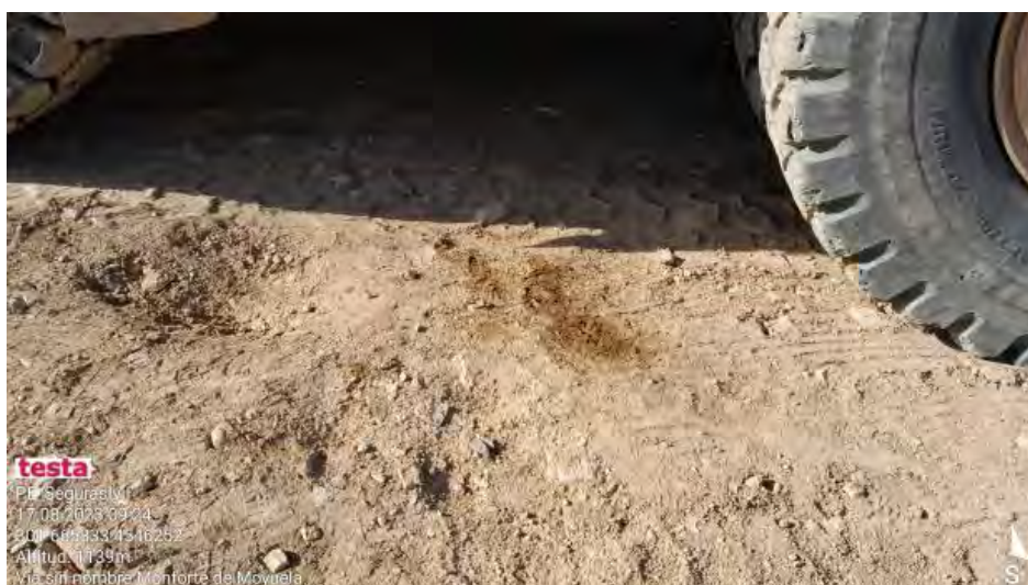
Maquinaria con fugas en campa de acopio.
