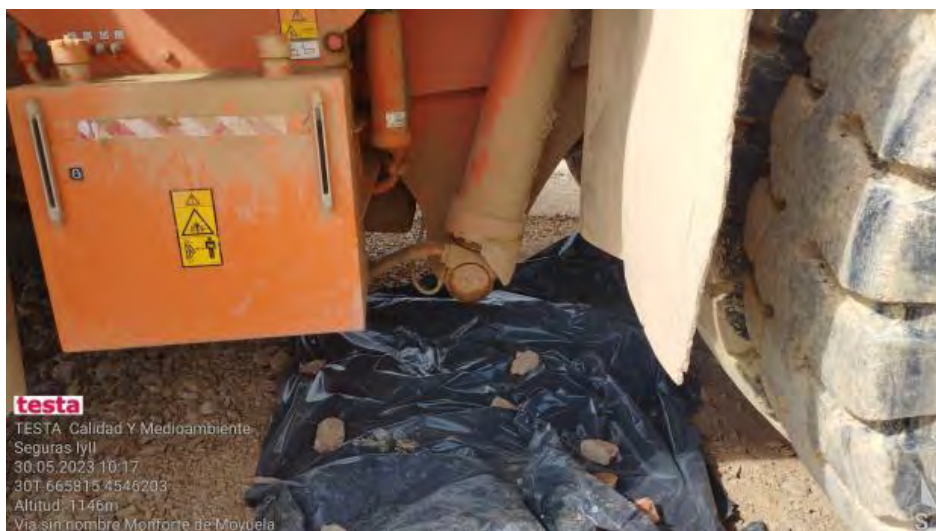
Fuga volquete solucionada parcialmente
