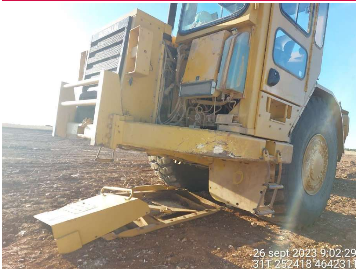
Maquinaria pesada parada con la protección del suelo.
