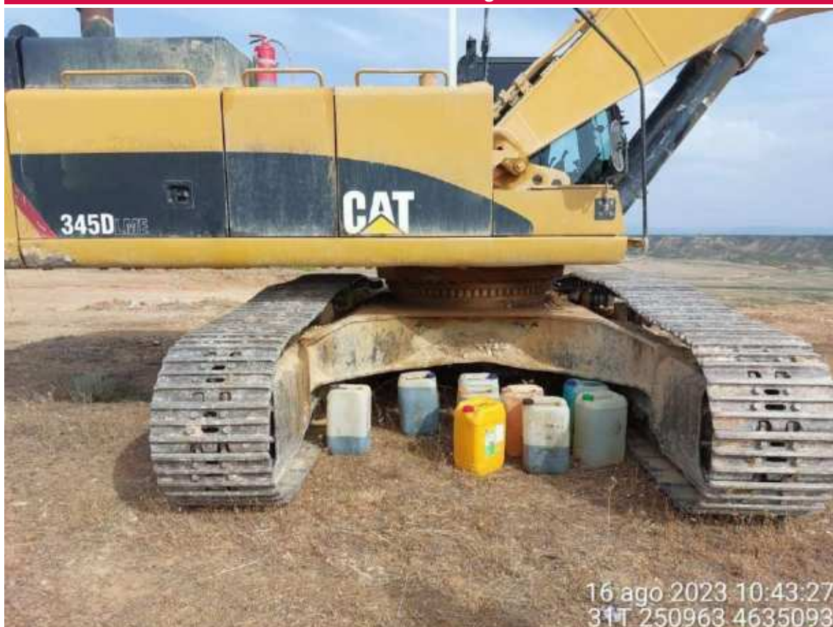
Imagen 2. Bidones de antisol y aceite sin cubeto de protección.
