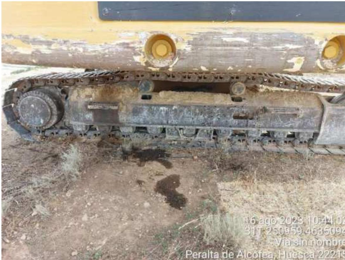
Imagen 1. No conformidad leve. Mancha de aceite por trabajos de reparación de maquinaria sin protección del suelo.
