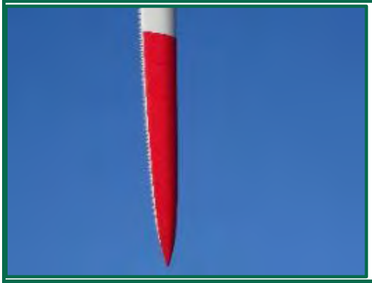
Fotografía 27. Pintado punta de las palas.
