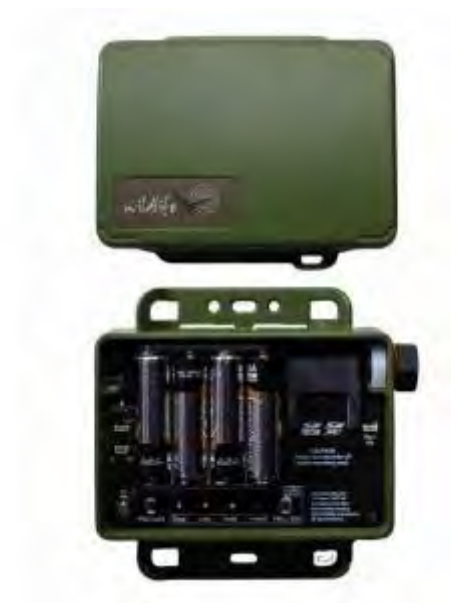
Figura 46. Mini Bat: vista del interior (a) y del exterior (b). Fuente: WildLife Acoustics.
