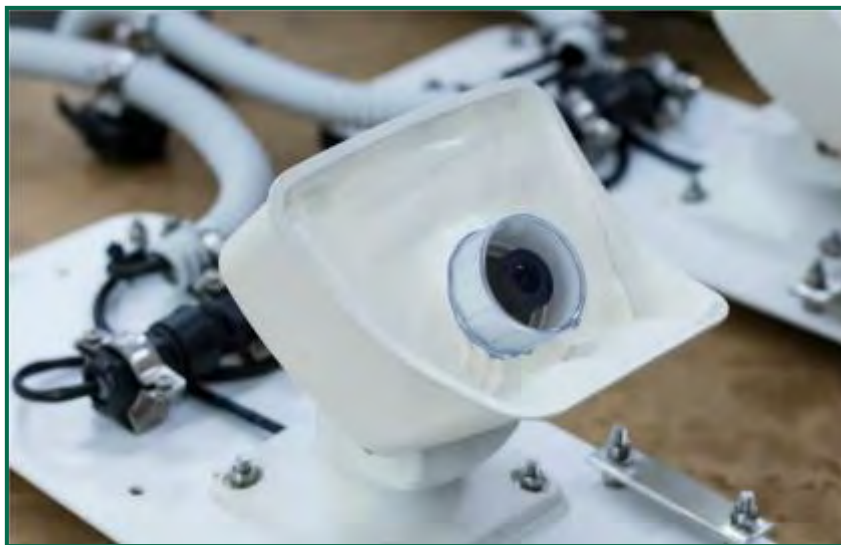
Fotografía 33. Nuevas carcasas para las cámaras de detección de DtBird.
