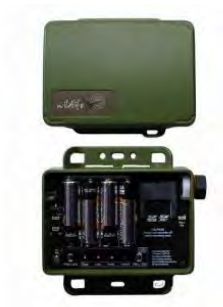
Figura 32. Mini Bat: vista del interior (a) y del exterior (b). Fuente: WildLife Acoustics.
