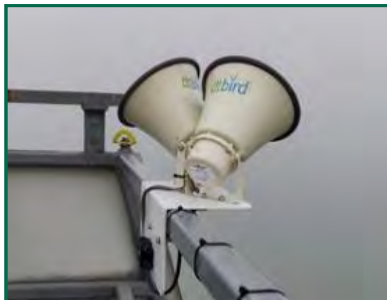
Fotografía 35. Sistema de anclaje de los altavoces.
