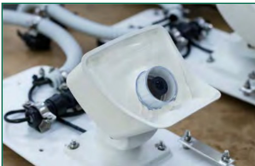
Fotografía 35. Nuevas carcasas para las cámaras de detección de DtBird.
