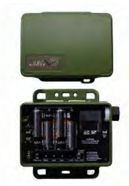
Figura 33. Mini Bat: vista del interior (a) y del exterior (b). Fuente: WildLife Acoustics.
