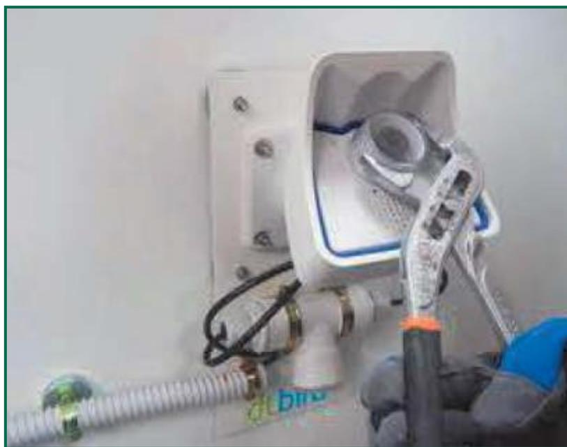
Fotografía 38. Cubrelente acoplado a la nueva cámara.
