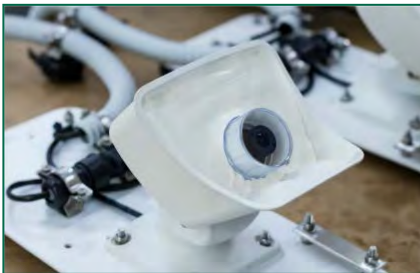
Fotografía 24. Nuevas carcasas para las cámaras de detección de DtBird.
