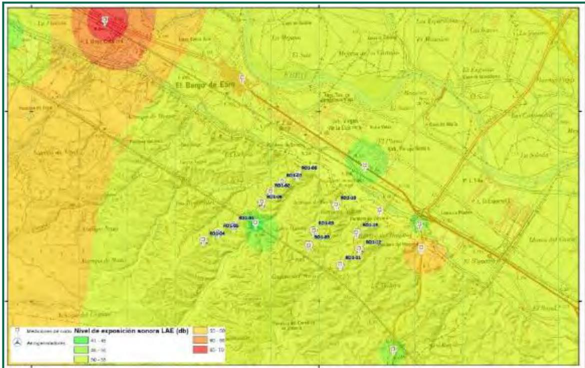
Figura 58. Distribución espacial hallada mediante dos tipos de interpolación diferentes (IDW) de los datos medidos en campo con una velocidad de viento entre 5 y 8 m/s y parques eólicos en funcionamiento.
