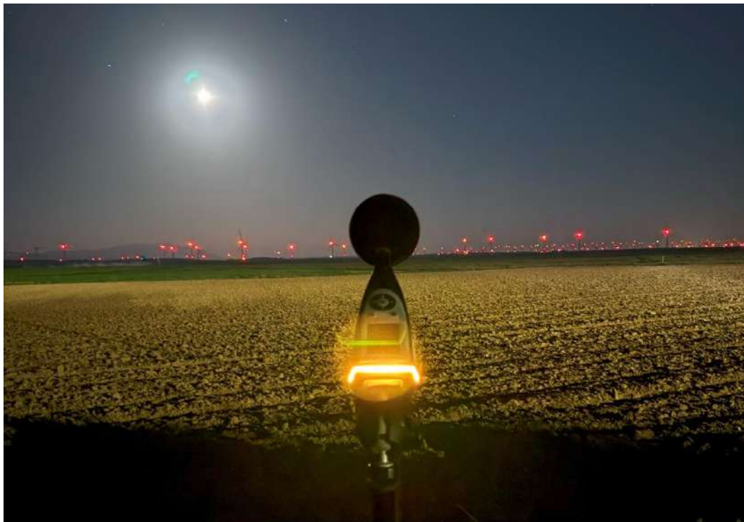
Foto nº1. Medición de ruido de fondo nocturno en el punto de medición RFPI-02.
