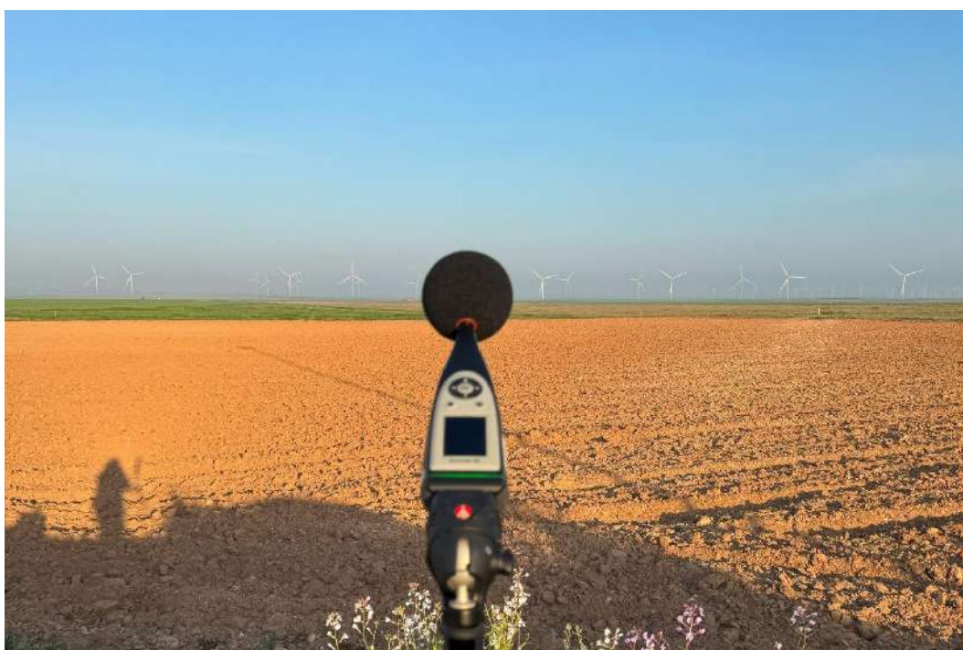
Foto nº2. Medición de ruido de fondo diurno en el punto de medición RFPI-02.
