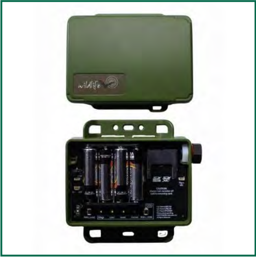
Figura 12. Mini Bat: vista del interior (a) y del exterior (b). Fuente: WildLife Acoustics.
