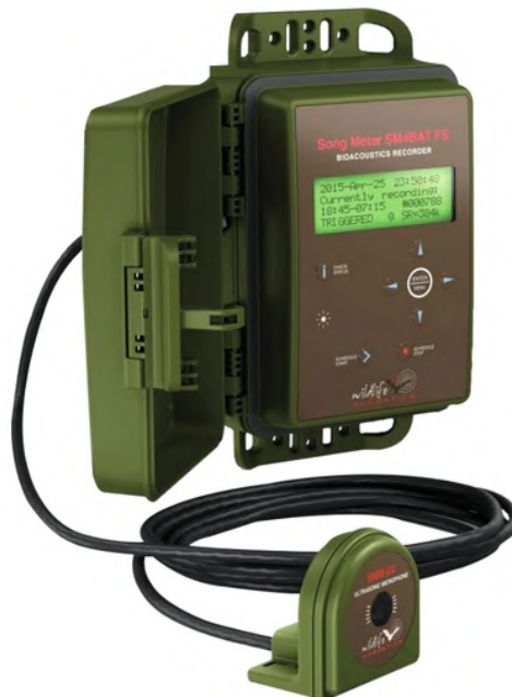
Figura 11: Detalle del dispositivo Song meter SM4 con su cubierta protectora abierta para mostrar la consola de programación y con un micrófono acoplado por cable. Más información del modelo puede consultarse en: https://www.wildlifeacoustics.com .
