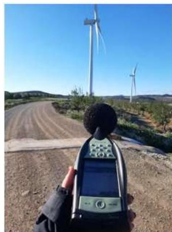
Figura 53: Sonómetro integrador modelo CESVA SC310 utilizado para la evaluación de los niveles de presión sonora para 2024.
