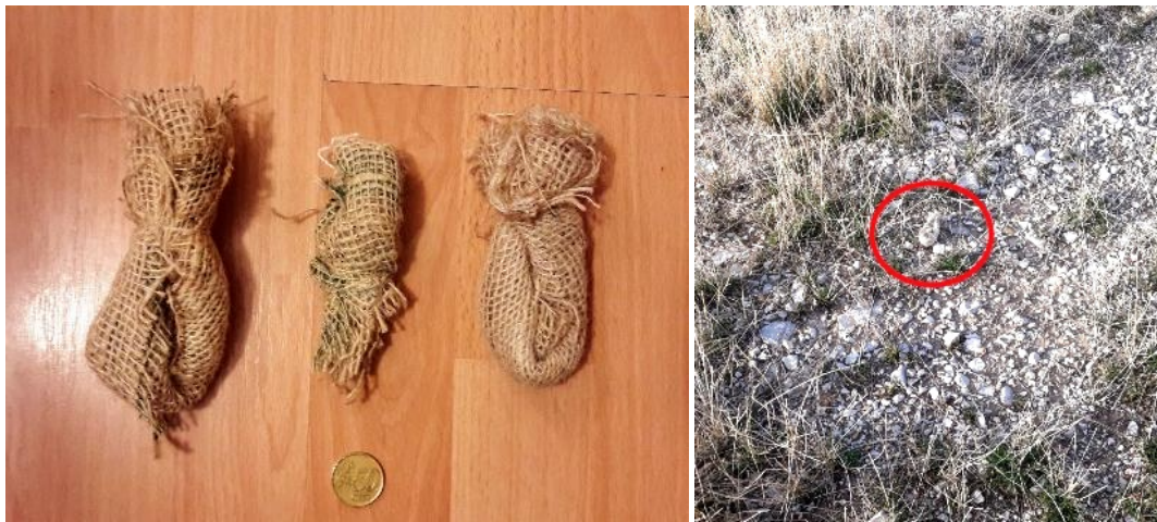
Figura 9: Ejemplo de señuelos empleados en el test de detectabilidad, y fotografía de uno de los señuelos ubicado en campo durante el test.
