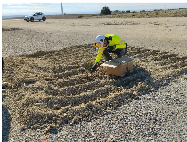
Toma de muestras en el punto en el que se produjo el derrame en la plataforma del SAR 03
