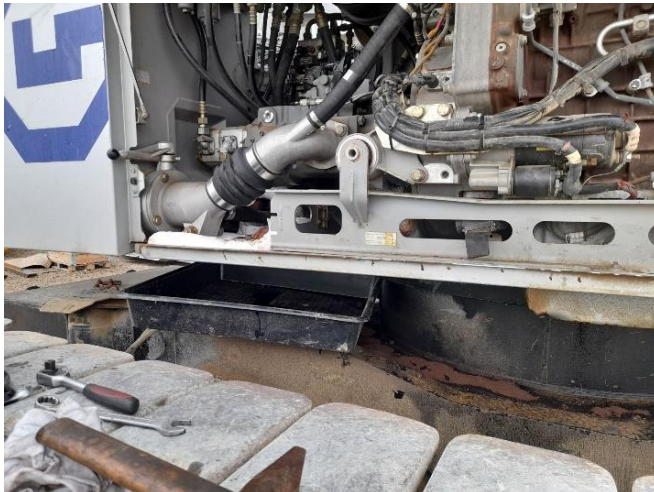
Medidas adoptadas para contener el derrame de la fuga de la grúa en el montaje del SAR 05.
