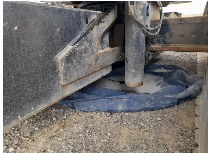
Medidas adoptadas para contener el derrame de la fuga de la grúa en el montaje del SAR 05.
