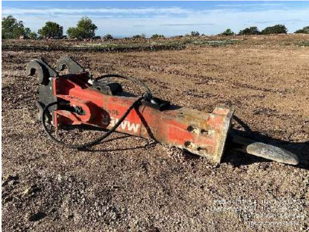
Martillo neumático en MR2-1 sobre suelo desnudo. Apertura de vial en acceso a MR2-8.
