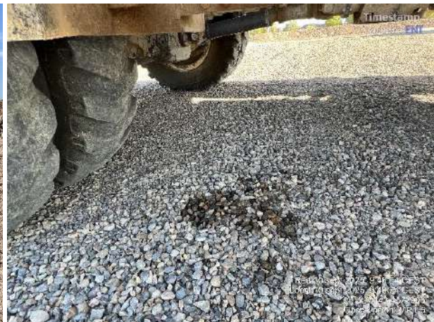
MR1-5, Superficie restaurada morfológicamente. Derrame por goteo en retroexcavadora.
