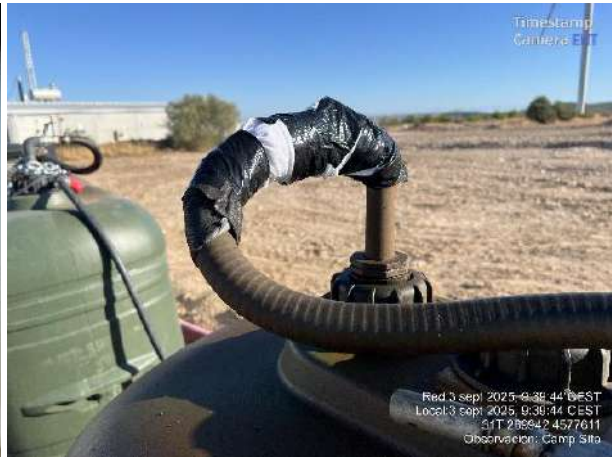
Bidón con fecha de envase no visible. Corrección de fuga de gasoil con material absorbente.
