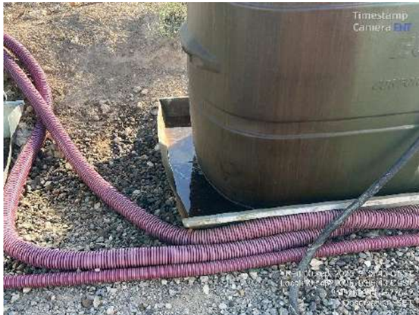
Bandeja antiderrame con nivel elevado de líquido contaminado. MR1-5, Restitución de lindero: aporte de T.V.
