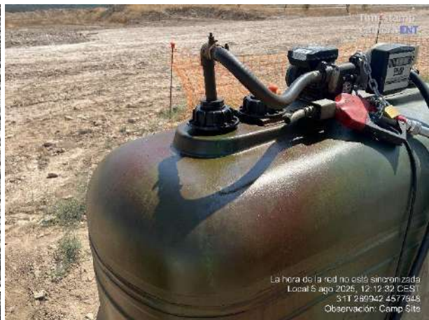
Pequeño derrame de aceite junto a contenedor de obra. Fuga en codo de surtidor.
