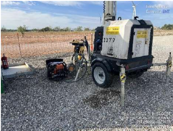
Derrame de gasoil junto a torre de iluminación. Etiquetado y estado correcto.
