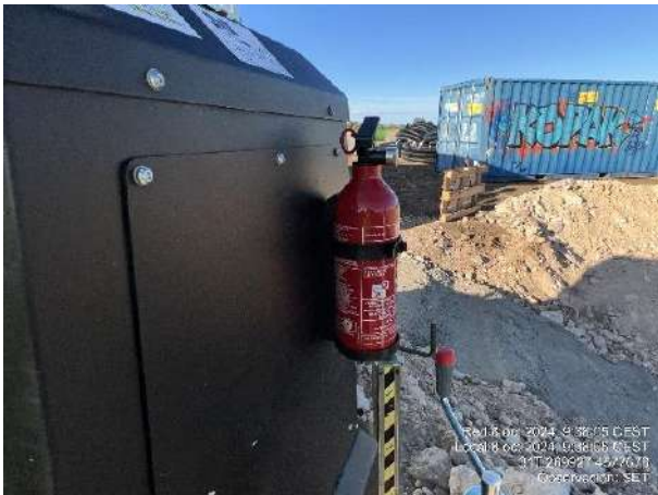
Focos con doble pared y extintor incorporado. Generador reubicado sobre bandeja antiderrame.
