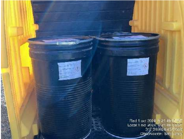
Nuevos bidones de R.P. con etiquetado correcto. Etiquetado de residuos N.P. no visible (corregido).
