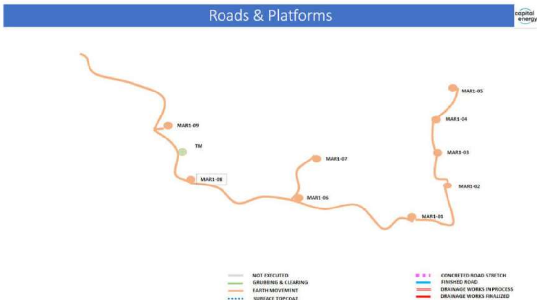
Figura 2. Estado y plano de obras ejecutadas a fin de mes.
