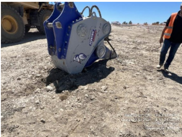
Manguitos hidráulicos sin bandeja antiderrame. Inicio de cimentaciones en MR1-8.
