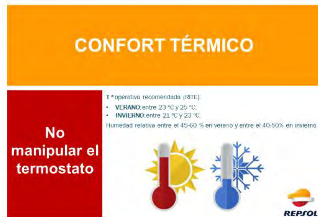
Figura 41. Señalización temperatura termostato en las SET.
