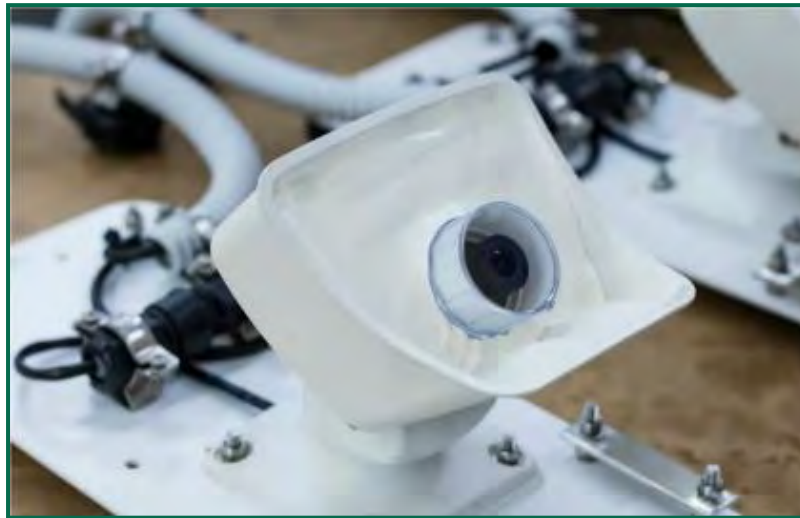
Fotografía 22. Nuevas carcasas para las cámaras de detección de DtBird.
