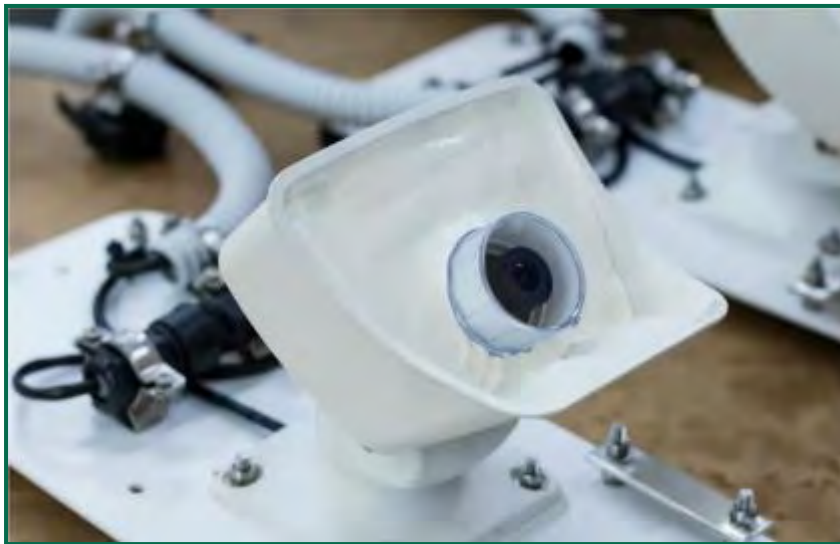
Fotografía 21. Nuevas carcasas para las cámaras de detección de DtBird.
