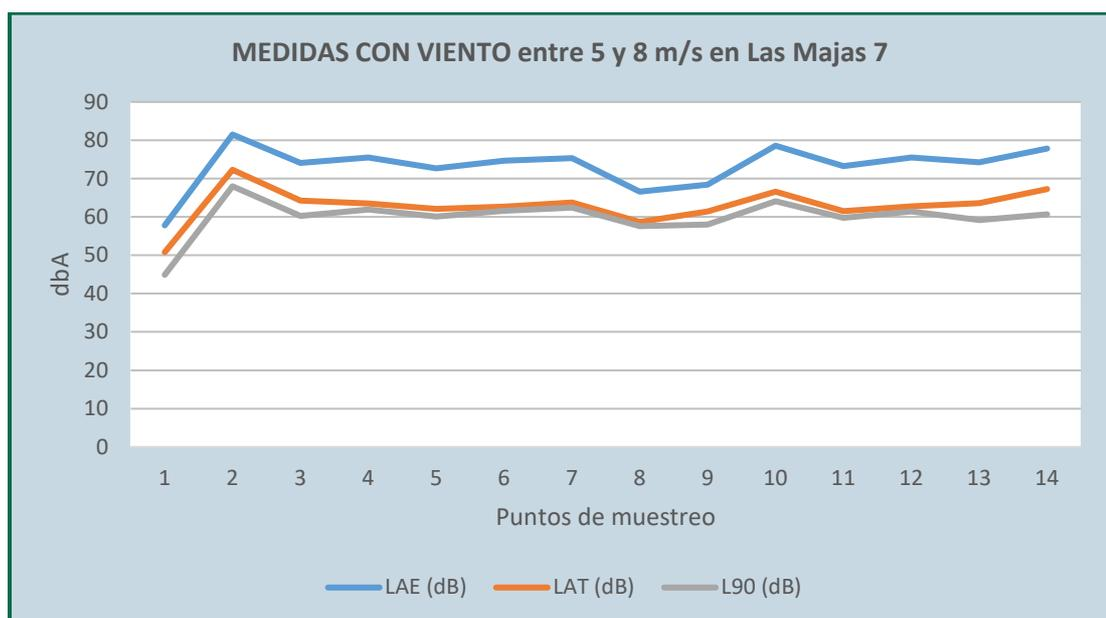
Figura 61. Registros en los puntos de medida., entre 5 y 8 m/s
