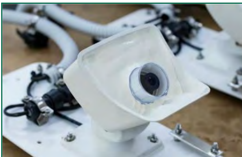
Fotografía 16. Nuevas carcasas para las cámaras de detección de DtBird.
