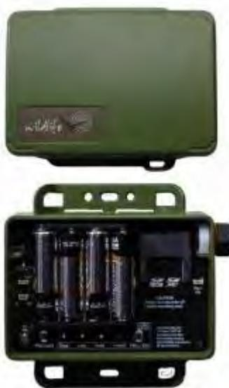
Figura 27. Mini Bat: vista del interior (a) y del exterior (b). Fuente: WildLife Acoustics.
