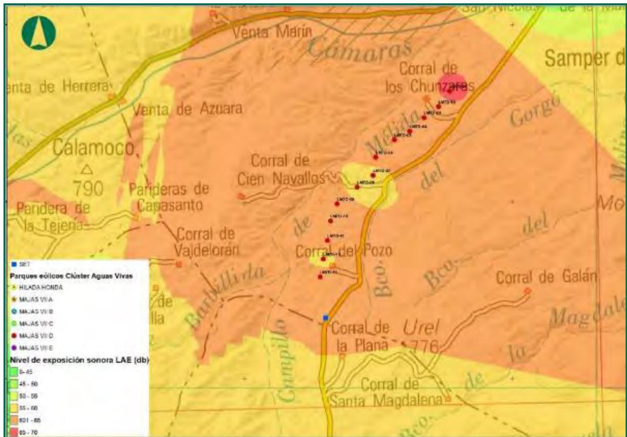
Figura 63. Distribución espacial hallada mediante dos tipos de interpolación diferentes (IDW) de los datos medidos en campo con una velocidad de viento entre 5 y 8 m/s y parques eólicos en funcionamiento.
