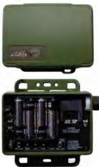
Figura 30. Mini Bat: vista del interior (a) y del exterior (b). Fuente: WildLife Acoustics.
