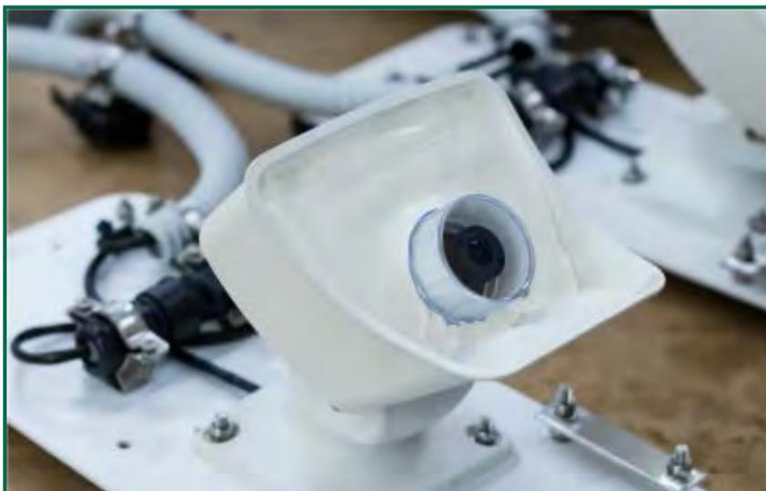
Fotografía 23. Nuevas carcasas para las cámaras de detección de DtBird.
