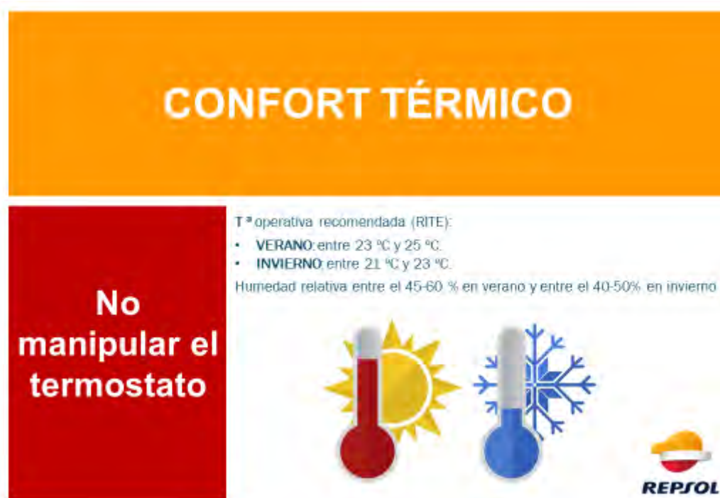
Figura 43. Señalización temperatura termostato en las SET.
