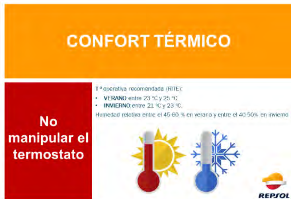
Figura 45. Señalización temperatura termostato en las SET.
