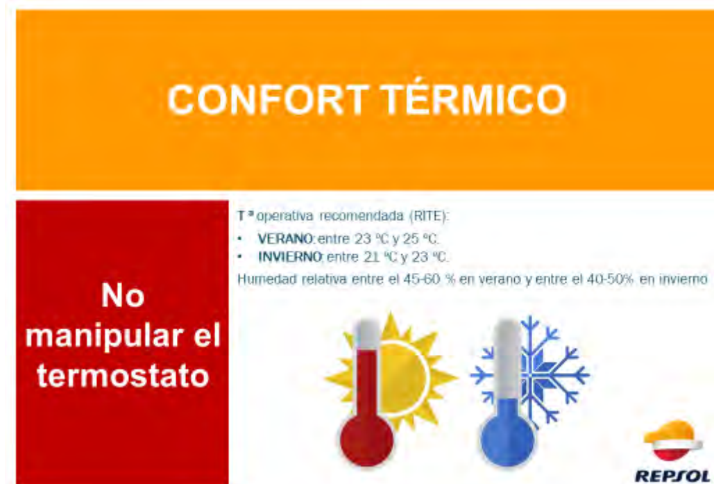
Figura 44. Señalización temperatura termostato en las SET.
