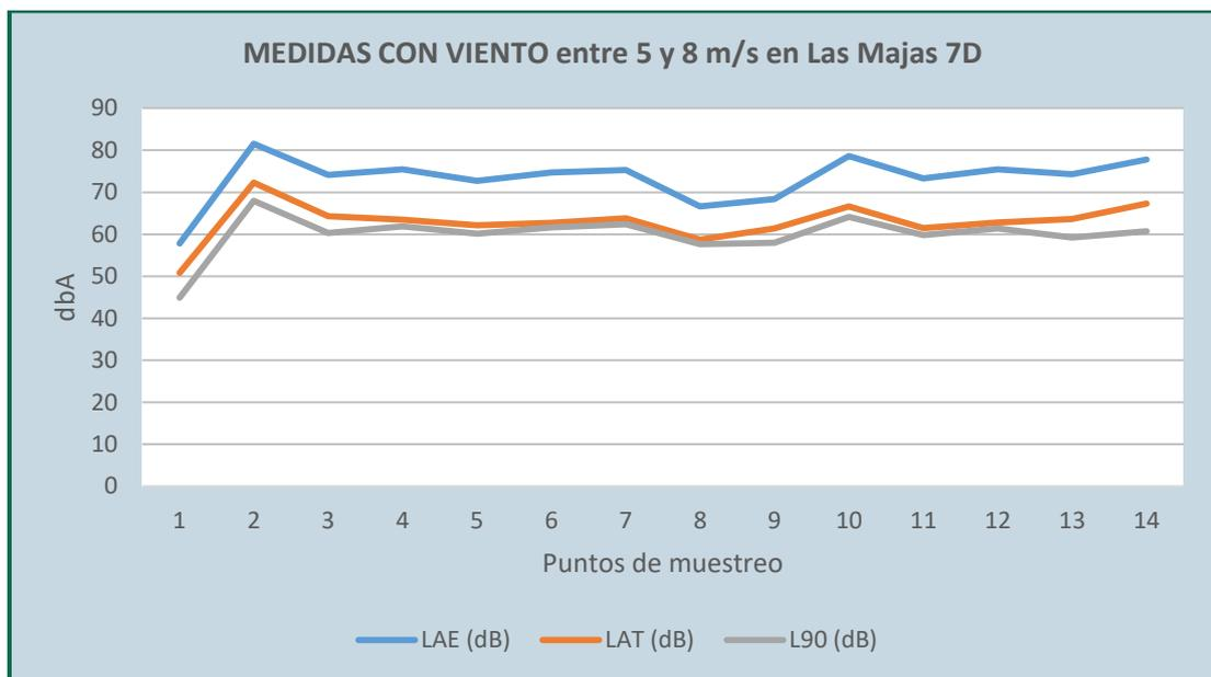
Figura 67. Registros en los puntos de medida., entre 5 y 8 m/s
